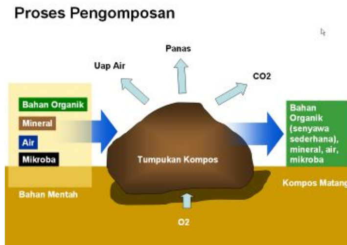
Gambar 1. Proses Umum Pengomposan Limbah Padat Organik (dimodifikasi dari Rynk, 1992)
