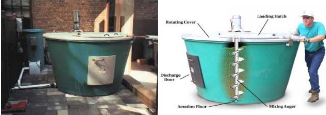
Gambar 9. Mechanical Compost Bins dan pengoperasiannya
